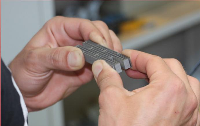
Échantillon d'une structure grillagée faite en acier à mémoire de forme
