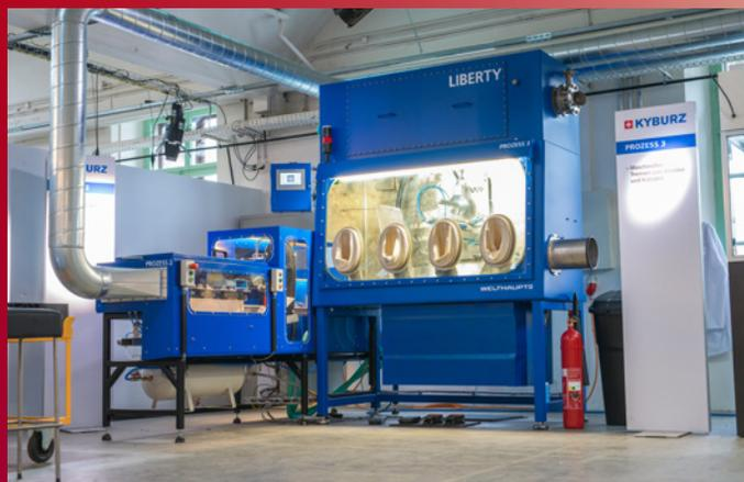
Système développé par Kyburz pour la découpe des batteries et l'extraction des électrodes destinées au recyclage
