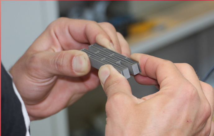
Musterbauteil einer Gitterstruktur aus Formgedächtnisstahl
